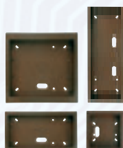
Montážna škatuľa vertikálna nad omietku (VNO): 4FF 090 81.1,2 128,6 x 130,0 mm škatuľa VNO pre 1-rám 4FF 090 82.1,2 225,1 x 130,0 mm škatuľa VNO pre 2-rám 4FF 090 83.1,2 321,6 x 130,0 mm škatuľa VNO pre 3-rám 4FF 090 84.1,2 225,1 x 227,2 mm škatuľa VNO pre 4-rám 4FF 090 86.1,2 321,6 x 227,2 mm škatuľa VNO pre 6-rám
